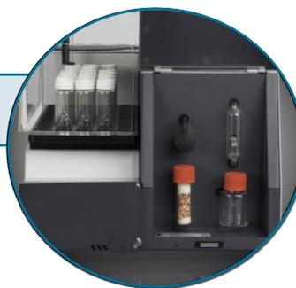
Анализатор Xpert-TOC/TN<sub>b</sub> имеет несколько интеллектуальных решений для легкой реализации методов TOC и TN<sub>b</sub>. Встроенные датчики постоянно контролируют такие параметры, как давление, расход и температуру. Когда срабатывает датчик, система немедленно отвечает, уведомляя пользователя.
