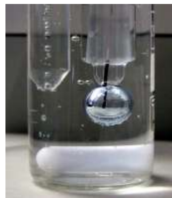
Трубка для титранта и pH-электрод в испытуемом растворе
